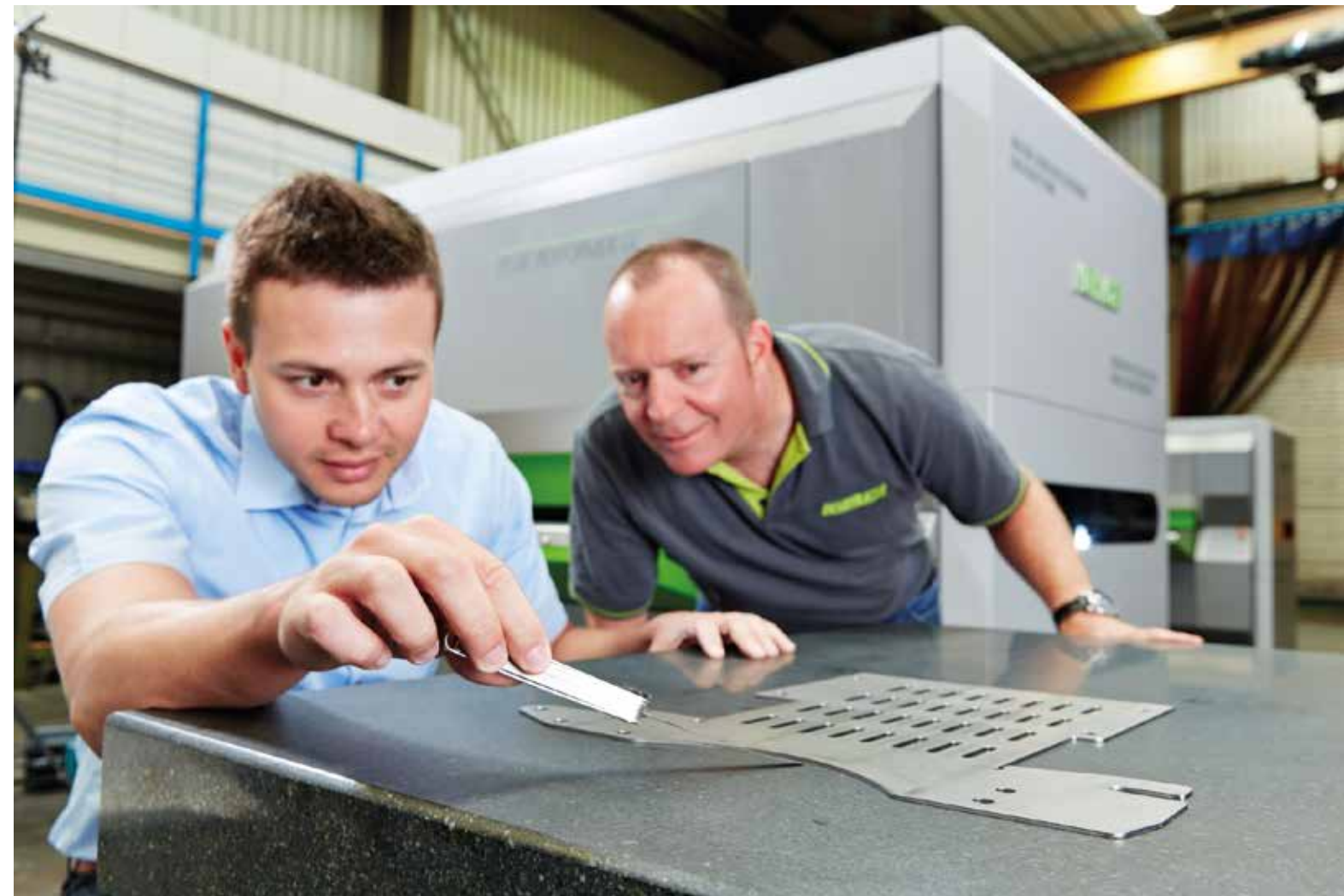
Gerichte plaatdelen zorgen voor minder spanning in het product
