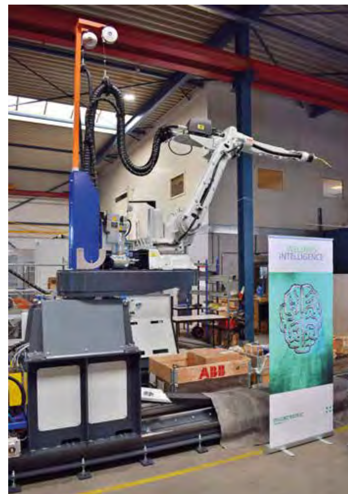
Naast het verzorgen van nieuwe automatiseringsoplossingen kan RobWelding ook bestaande systemen vernieuwen. Met behulp van een track, een extra as of een zwenkarm kan het bereik vergroot worden en is het mogelijk om meer functionaliteiten toe te voegen
