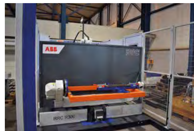
De Ready Robotic Cell is de kant-en-klare robotcel van RobWelding. Deze automatiseringsoplossing is in één dag operationeel
