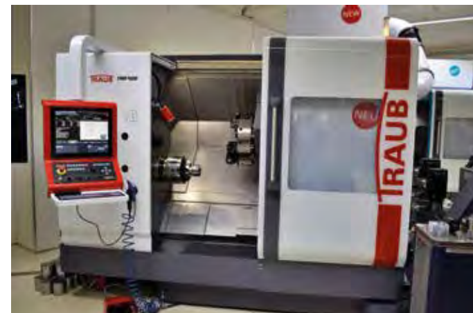
De nieuwe Traub TNA400 universele CNC-draaimachine heeft een gemeenschappelijk platform met de nieuwe Index B400. Het grootste verschil tussen de twee draaimachines is de besturing
