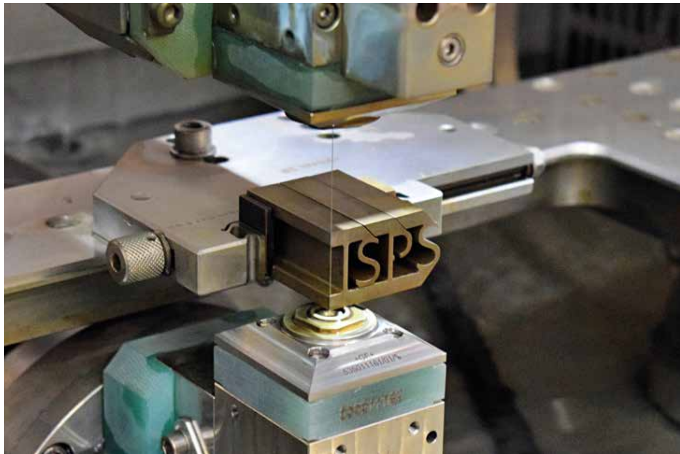
Spark Track bepaalt de locatie van de vonkoverslag en past automatisch de parameters aan, zodat draadbreek wordt voorkomen bij onderbroken sneden
