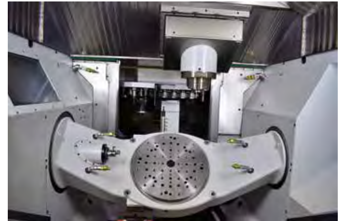
De portaalconstructie van de FZ 16 zorgt voor meer stabiliteit en nauwkeurigheid. De spil wordt in de Y-richting ver ondersteund
