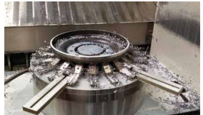
Ingespannen wiel, na afloop van de bewerking.
