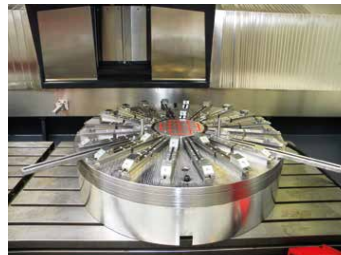
Het magnetisch opspansysteem met de twee verstelbare aanslagen, de 12 centrale kwadraatpolen, en daaromheen de (17 variabele en 3 vaste) radiale polen. De machine heeft twee van dergelijke systemen i.v.m. de pendelbewerking.
