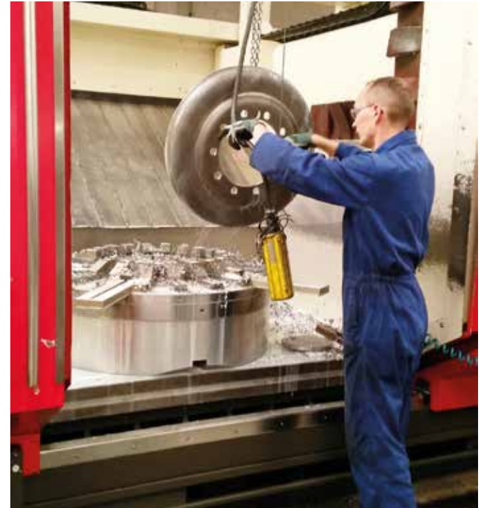
Werkstukken worden eenvoudig met de kraan in het ene deel van de machine geladen terwijl in het andere deel de bewerking voortgaat.
