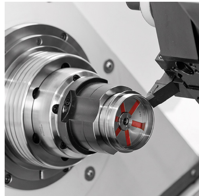
Door een werkstuk intern op te spannen met een doorn kan het werkstuk in één opspanning volledig bewerkt worden
