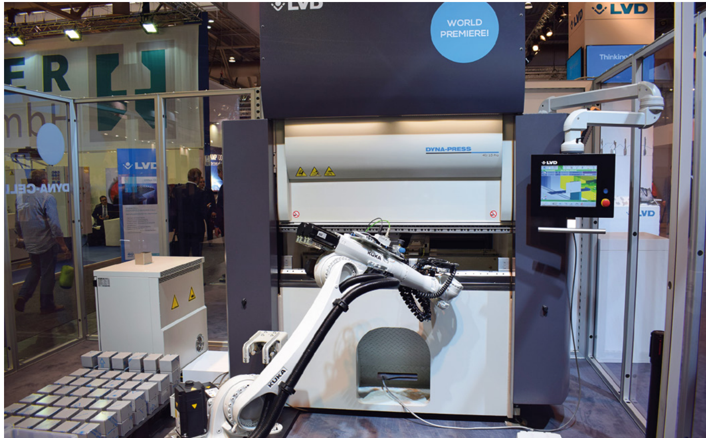
Met de nieuwe Dyna-Cell presenteert LVD een geautomatiseerde oplossing voor het kanten van middelgrote series
