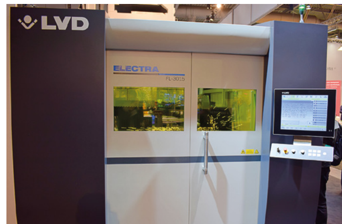
Laservermogens voor fiberlasers gaan nog steeds omhoog. LVD biedt op de Electra FL-3015 nu ook de mogelijkheid om deze met 10 kW uit te rusten
