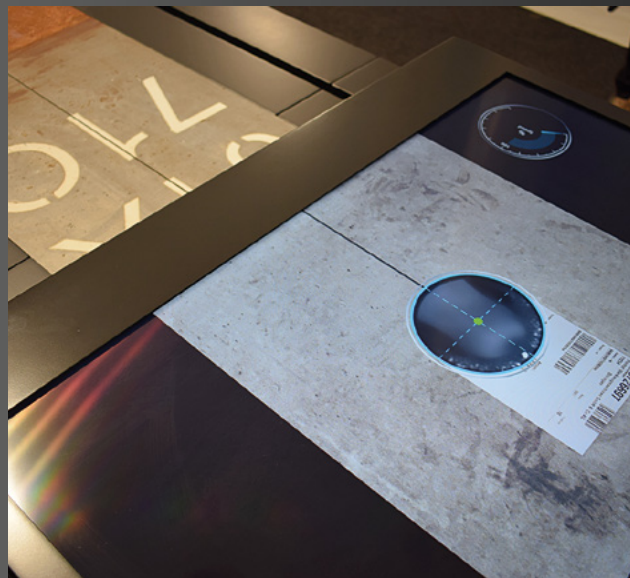
Active Speed Control kijkt door de nozzle op het snijvlak en past automatisch de snijsnelheid aan
