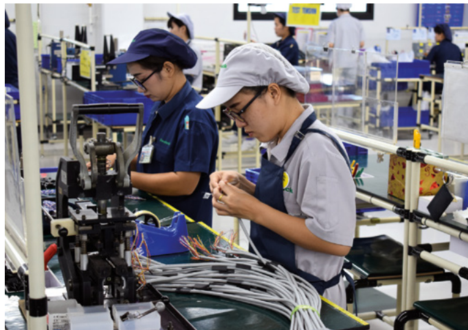
Sodick maakt alles in eigen beheer. Een mooi voorbeeld is bijvoorbeeld de kabeling
