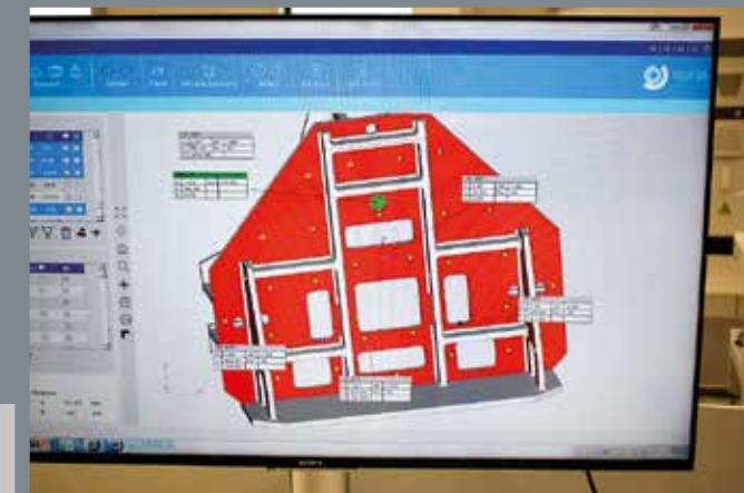
De Visup 3D software helpt de werknemer om stap voor stap het werkstuk in beeld te krijgen
