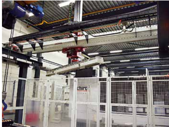
Het gantry-systeem kan de werkstukdragers van bovenaf in de machine beladen. Hierdoor kan de productiehal efficiënter worden ingericht
