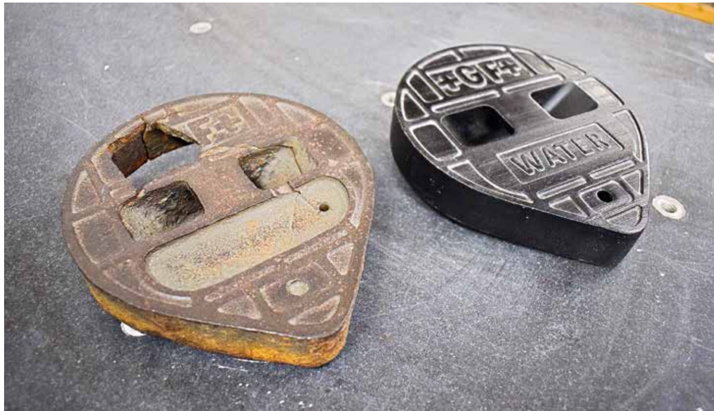
Met reverse engineering heeft 3D Makers Zone in samenwerking met waterleidingbedrijf PWN deze 3D-geprinte putdeksel ontwikkeld. De nieuwe putdeksel is voorzien van sensoren om belangrijke waardes te meten die op afstand uitgelezen kunnen worden
