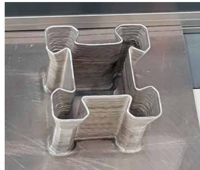
Aluminium product in de vorm van een kasteel: 3D gelast product met behulp van synchrofeedlasproces
