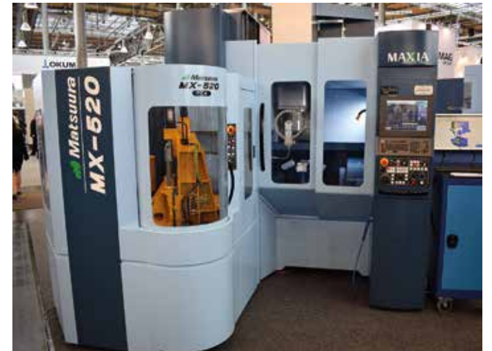
De vijfassige Matsuura MX-520 PC4 met een eigen palletautomatisering
