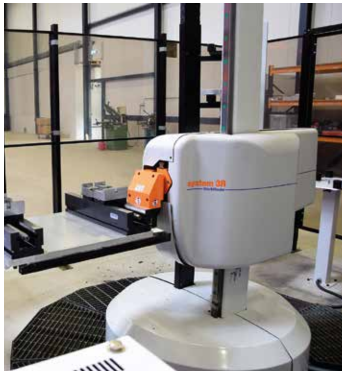
De System 3R Workmaster palletautomatisering bij GP Tooling & Engineering met grotere pallets dan standaard
