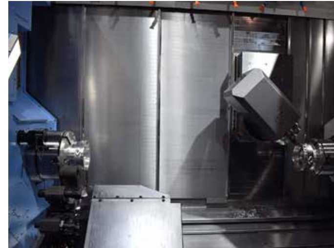
De nieuwe Doosan Puma SMX 3100ST is voorzien van een spil, tegenspil, frees- spil en een onderturret
