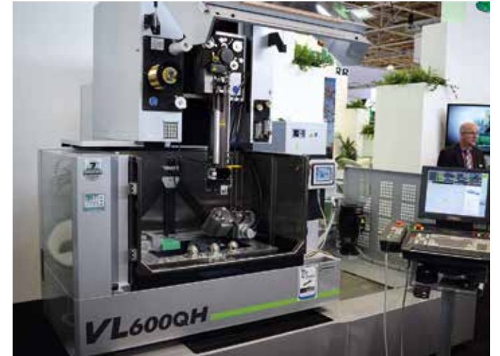
De VL600QH van Sodick is voorzien van een grotere Z-as en werd op de beurs gepresenteerd met twee extra assen voor het vonken van complexe producten
