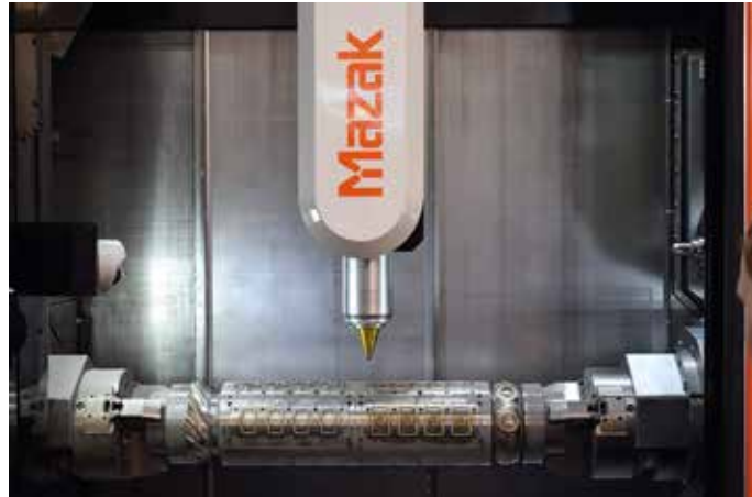
De nieuwe Integrex i-300S AM van Mazak combineert additieve productie-techniek door middel van laseroplassen met traditioneel vijfassig verspanen. De combinatie kan bijvoorbeeld gebruikt worden voor het repareren van dure slijtagdelen
