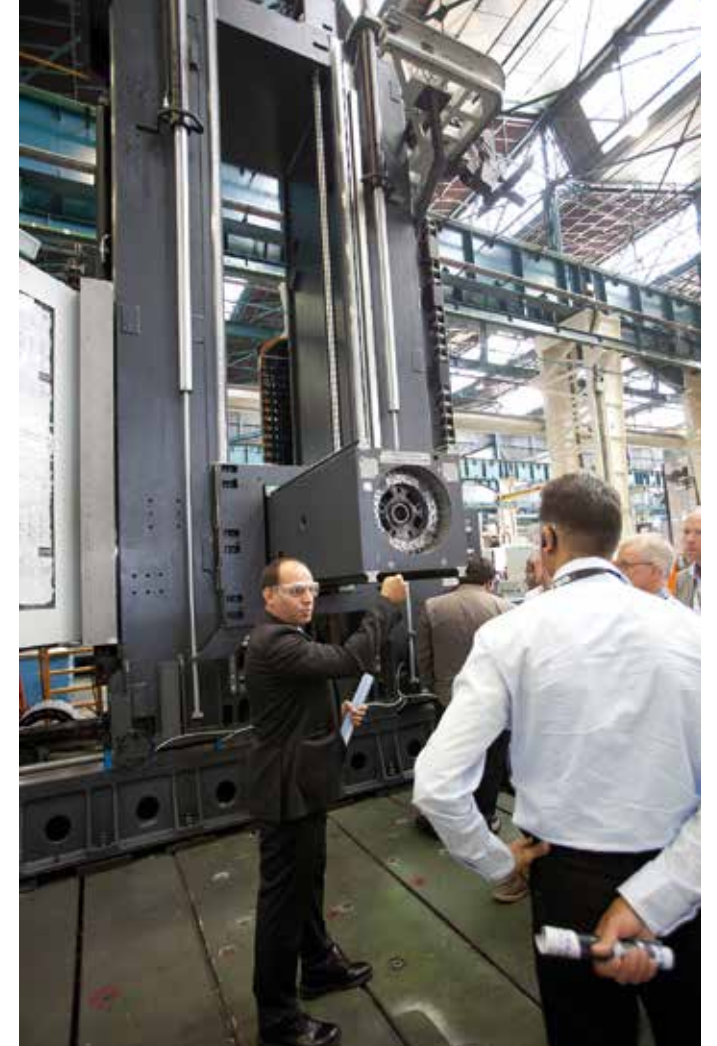
Om te zorgen dat dezelfde nauwkeurigheid wordt geleverd bij een maximale uitslag van de ram, wordt de ram bij de FOX serie bridge-type machines volgens het box-in-box principe geleid
