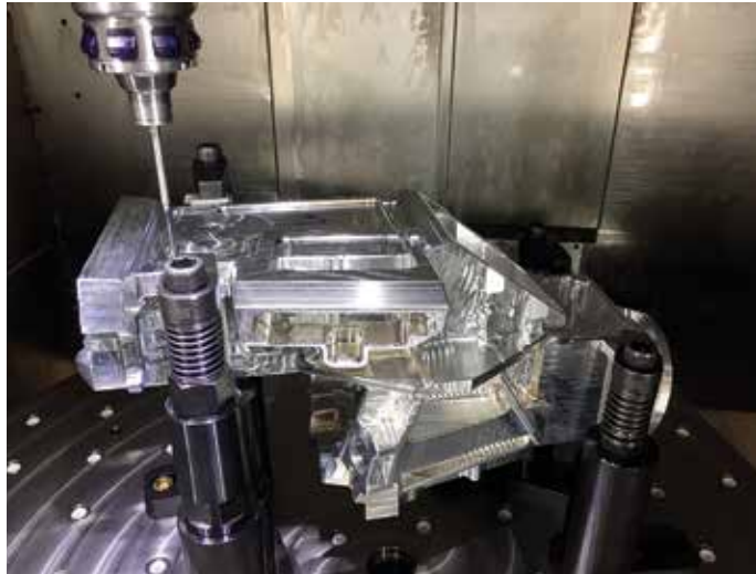
Een werkstuk dat net is voorgefreed. De bewerkingsruimte stelt Kusters in staat om grote werkstukken vijfassig te bewerken (foto's: Kusters)
