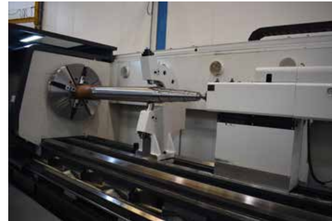
De Gurutzpe wordt ingezet voor de bewerking van zowel kleine als grote werkstukken. Aan de achterzijde van de machine zijn de openingen van de speciale AFS-afzuiging te zien
