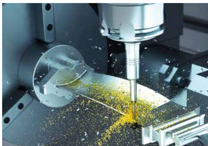
De koelkanaal technologie van Mikron Tool zorgt o.a. voor langere standtijden
