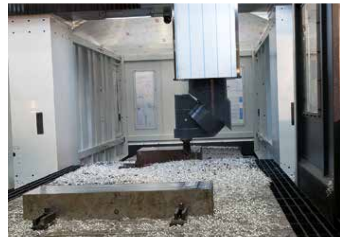
Dankzij de hoge machinestabiliteit is de FOX geschikt voor grove freesbewerkingen
