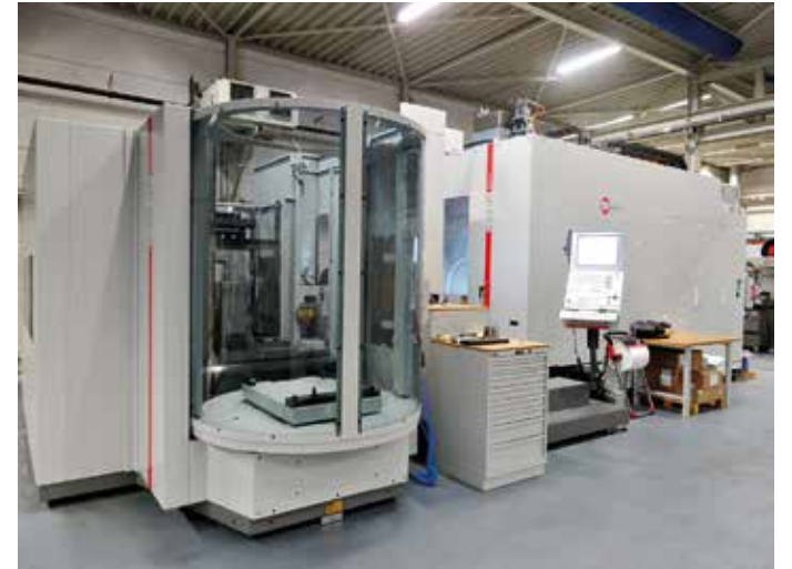
Het C 62 UP bewerkingscentrum is uitgerust met een palletautomatisering voor onbemand produceren en het eenvoudig handelen van spoedopdrachten
