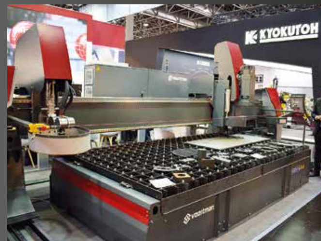
De V310 plasmasnijmachine van Voortman is voorzien van een boorunit voor meer functionaliteit. De inzet toont de boorunit
