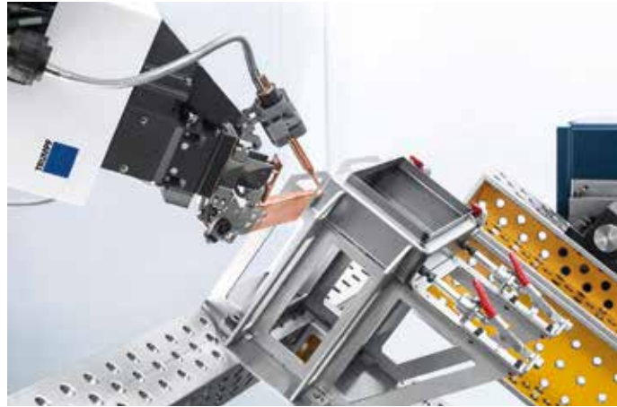
Soms kunnen lasprocessen efficiënter worden door een andere lastechnologie toe te passen zoals bijvoorbeeld laserlassen (foto: Trumpf)
