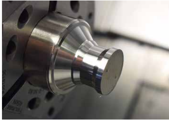
Harddraaien van gehard staal met een hardheid van 60 - 62 HRC
