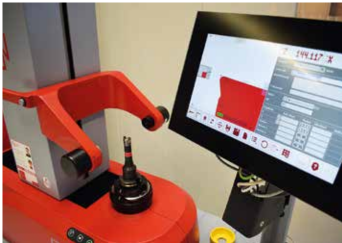
Metten en voorinstellen op een EZset 420 voorinstelapparaat
