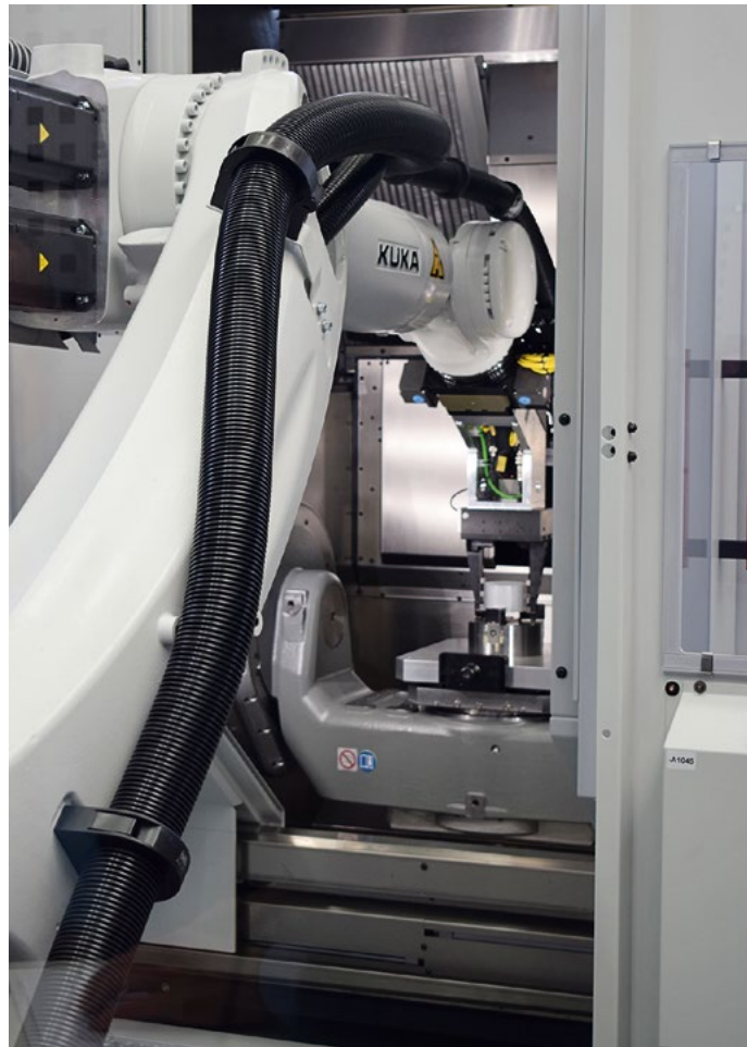
De zesassige robot van het RS 2 Combi robotsysteem legt een werkstuk in de C 32 U Dynamic
