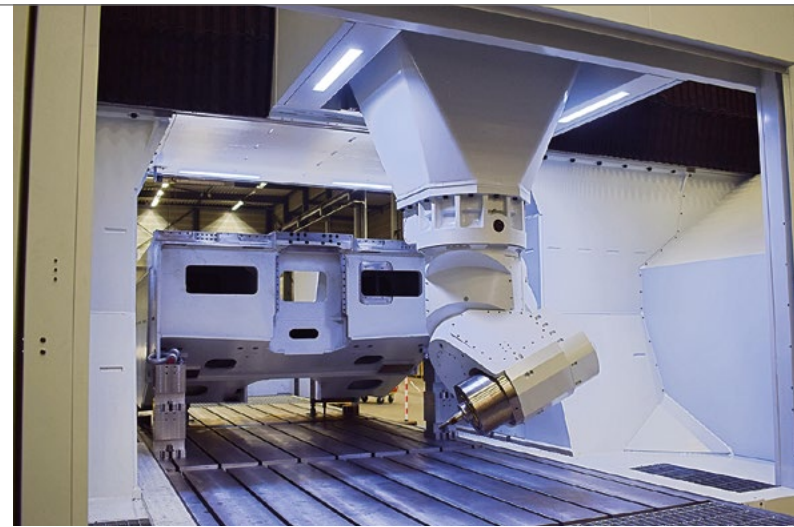
De Uniport 6000 HV heeft een vaste freeskop die op een vijftig graden vlak staat. Hierdoor wordt er niet ingeleverd op de Z-as wanneer de freeskop van horizontaal naar verticaal bewerken gaat
