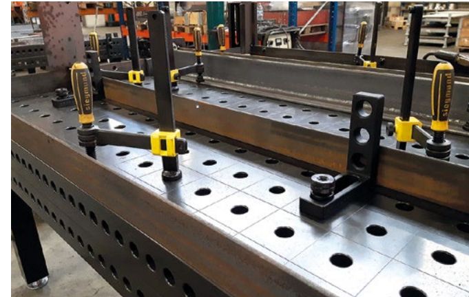
Met de opspantafel van Siegmund is het mogelijk om een honderd procent haakse opstelling te creëren
