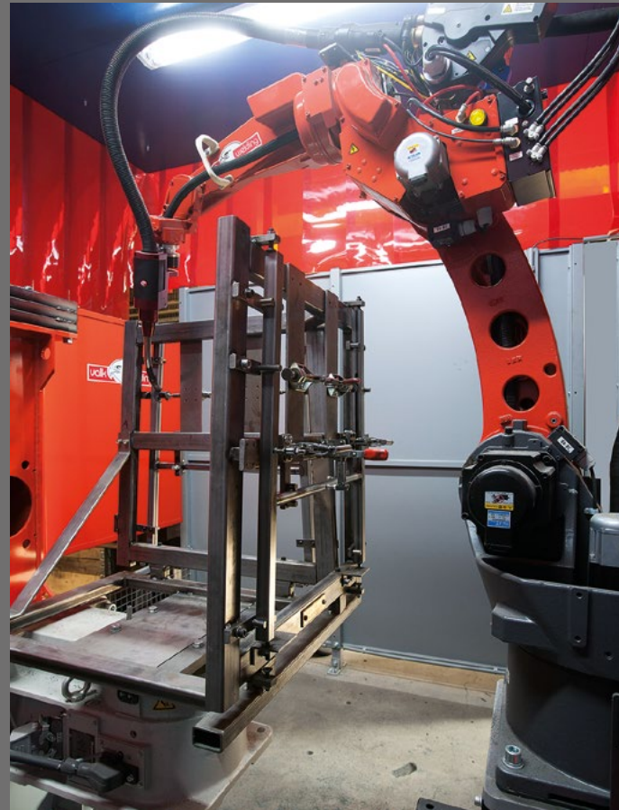
De vierde lasrobot bij VDS Van der Sluis verkort de productietijd en verbetert de kwaliteit
