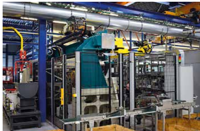
Walraven heeft het plaatsen van gereedschappen geautomatiseerd met behulp van RFID en een robot. Dankzij modulaire stempels kunnen de omsteltijden verder verlaagd worden
