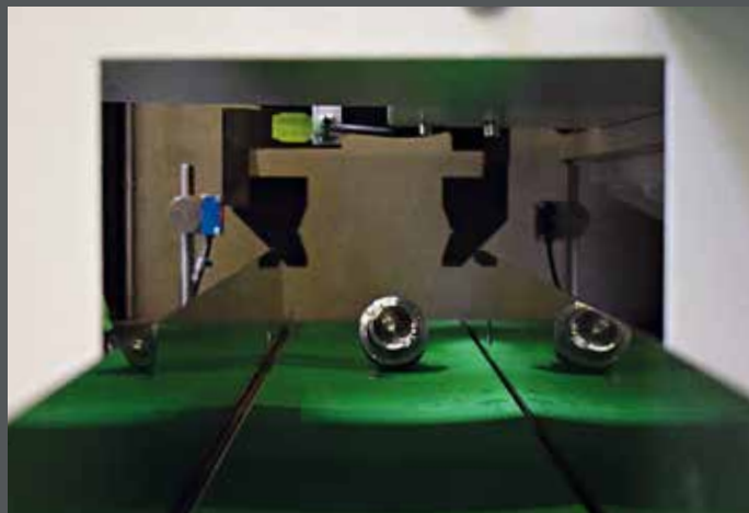
Verschillende vormen van automatisering, zoals dit werkstukuitnamesysteem met grijper, maken de productie flexibel
