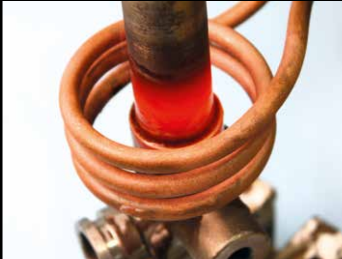
Inductieverwarming wordt bijvoorbeeld toegepast voor solderen
