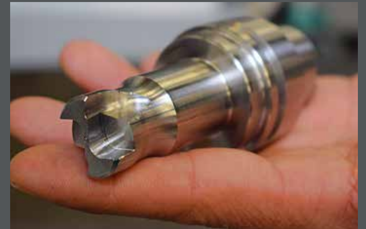
Het freesdraaicentrum kan werkstukken vanaf staf compleet vijfassig bewerken. De MT 733 Two heeft daarvoor twee freesspillen, een hoofdspil en een tegenspil
