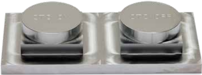
CTC compenseert de positieafwijking van het middelpunt van het gereedschap bij versnellingen van de assen. Zo ontstaat een hogere nauwkeurigheid
