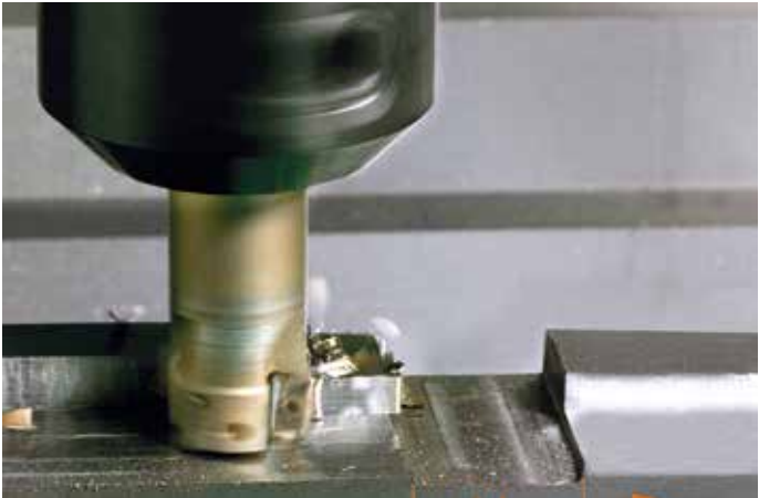
AFC optimaliseert de voedingssnelheid aan de hand van het spilvermogen en andere procesgegevens
