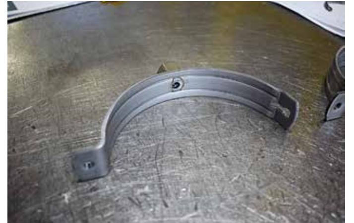
Deze beugel komt kant en klaar van de stanslijn
