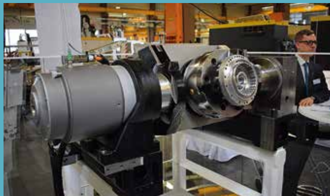
De Galaxie aandrijving voorkomt slijtage, is stijf, nauwkeurig en ingebouwd in de B-as van de MT 733
