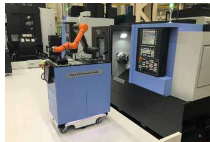
Tijdens de DIMF presenteerde Doosan een cobot op een AGV die een product vanuit een Lynx draaimachine naar een DNM bewerkingscentrum bracht. Ook de logistiek is te automatiseren
