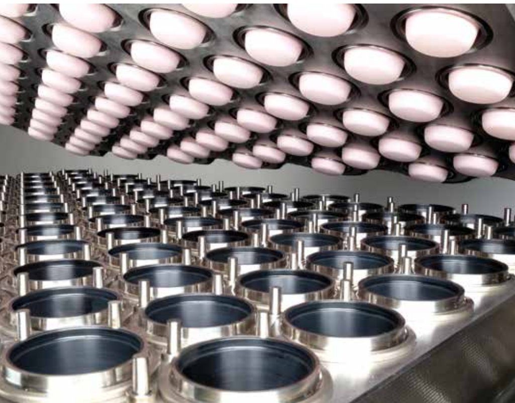
Met de matrijzen die Kiefel ontwikkelt en maakt kunnen 24/7 kunststof verpakkingsmaterialen geproduceerd worden. De matrijzen worden eerst allemaal uitvoerig getest in een eigen testcentrum
