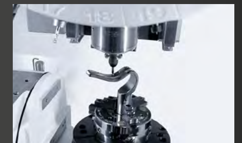
De nieuwe DMP 70 is een compact bewerkingscentrum. De geïntegreerde draai-zwenktafel maakt vijfassige simultaanbewerking mogelijk (foto: DMG Mori)
