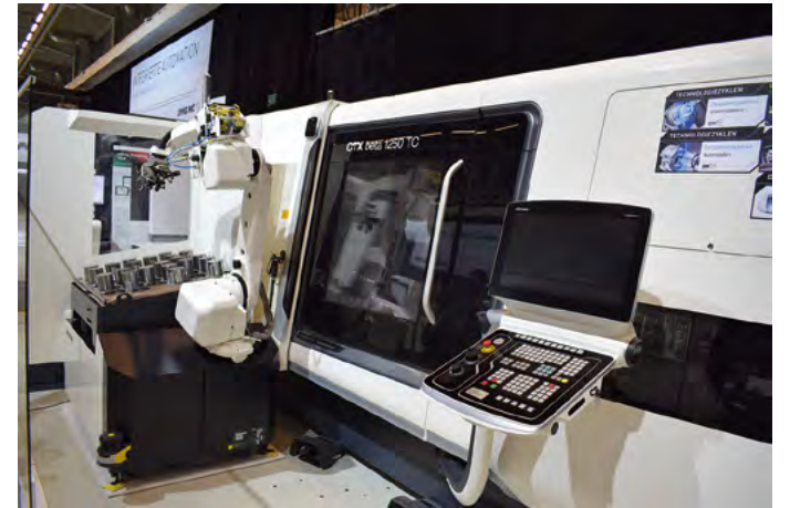
De Robo2Go maakt het mogelijk om CNC-draaibanken te automatiseren
