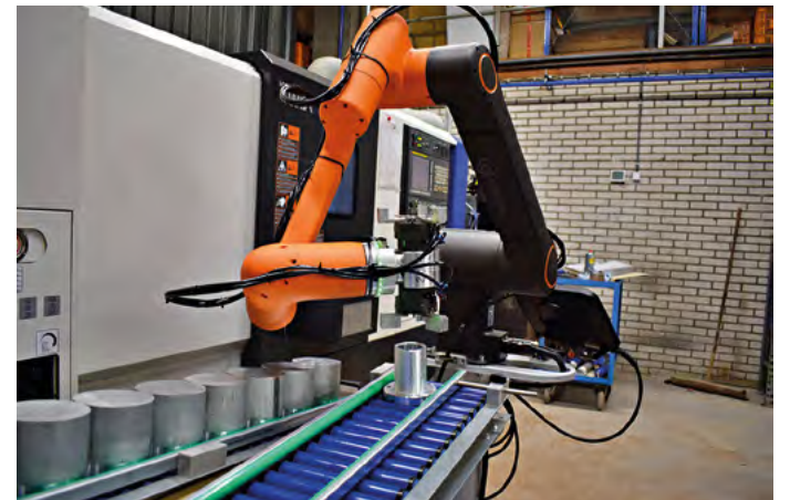
Dankzij de ingebouwde veiligheid kan de cobot zonder veiligheidshekken bij de machine werken. Dit scheelt een hoop ruimte
