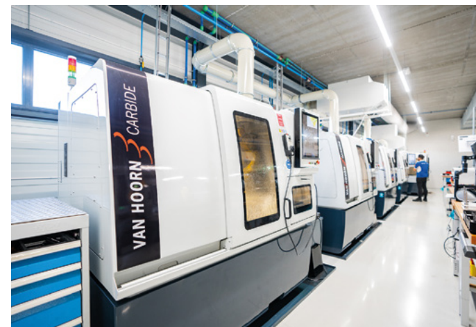
Van Hoorn Carbide heeft een modern machinepark, met CNC-machines die niet ouder zijn dan vijf jaar. De slijpmachines zijn ondergebracht in een geconditioneerde ruimte om een hoge maatnauwkeurigheid te kunnen garanderen
