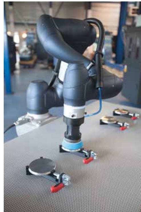
Links: De UR Family met een draagkracht van 3, 5, 10 en 16 kg en een reikwijdte van 0,5 tot 1,3 m. Onder: De HCT-1200 tafel is speciaal ontworpen voor het beladen van metaalbewerkingsmachines met een cobot. Rechts: De force torque sensoren van de Doosan cobot zorgen voor een constante kracht, bijvoorbeeld bij het polijsten van werkstukken.
