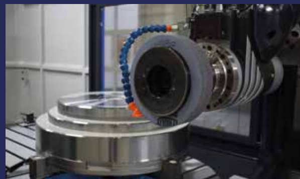
Soraluce heeft het slijpproces ook geïntegreerd in haar multitasking machines
