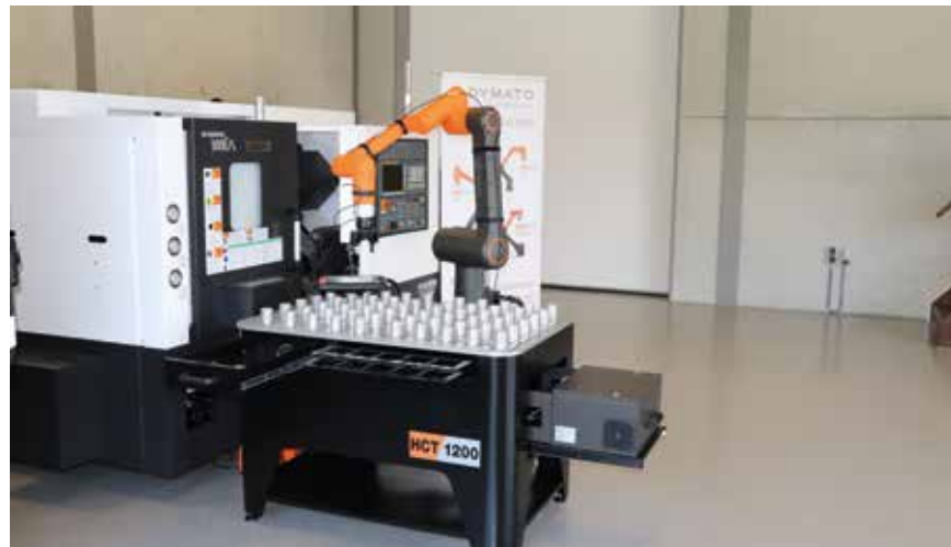
Links: De UR Family met een draagkracht van 3, 5, 10 en 16 kg en een reikwijdte van 0,5 tot 1,3 m. Onder: De HCT-1200 tafel is speciaal ontworpen voor het beladen van metaalbewerkingsmachines met een cobot. Rechts: De force torque sensoren van de Doosan cobot zorgen voor een constante kracht, bijvoorbeeld bij het polijsten van werkstukken.
