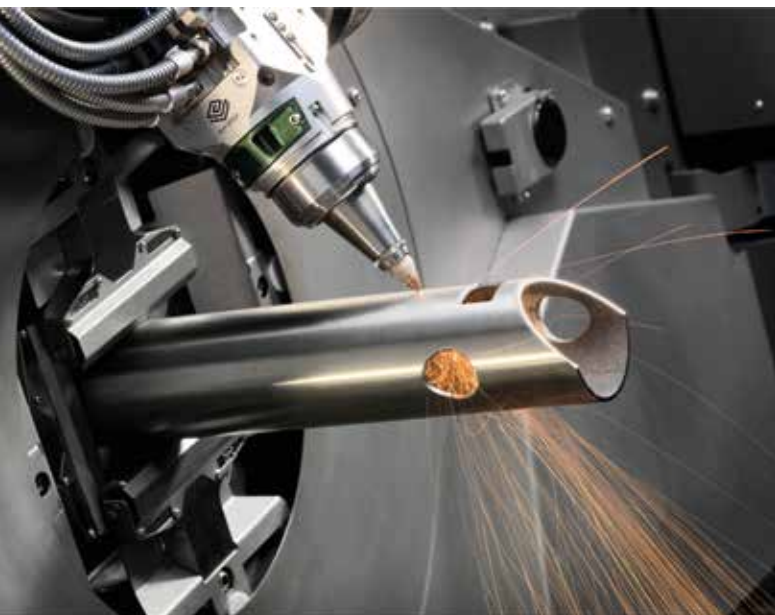
3D-lasersnijden biedt veel vrijheid in de te snijden contouren.
