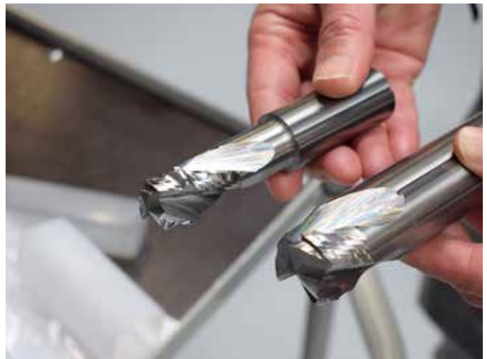
Een voorbeeld van een combigereedschap dat door Vereijkens is ontwikkeld en geproduceerd
