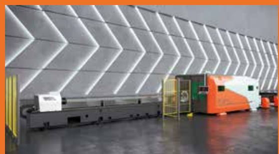
De Vento Flex kan zowel plaat als profielen snijden.
