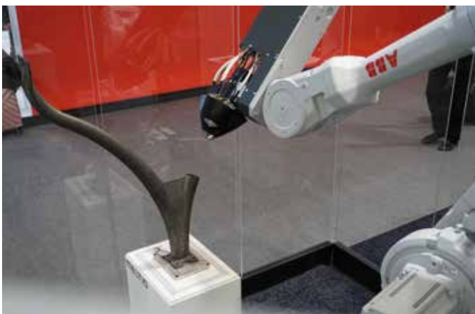
Meltio 3D print bij K3D onder andere dit onderstel voor de broodbaklijnen van Kaag in Terborg.
