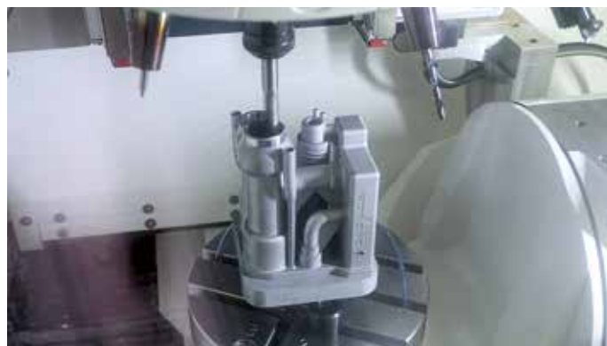
DMG Mori demonstreert de integratie van 3D-metaalprinten in de fijnmechanische verspanende bewerking. De Lasertec SLM-systemen gebruiken de nulpuntspansystemen die ook op de CNC-machines worden gebruikt, zodat onderdelen direct op de machine kunnen worden opgespannen.
