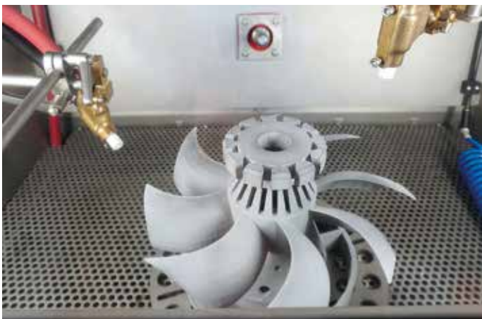
AM Solutions, de AM-tak van Rosler, heeft de S1 ontwikkeld voor het natstralen van onder meer metaalgeprinte onderdelen. De S1 zorgt voor semi-geautomatiseerd nabewerken.
