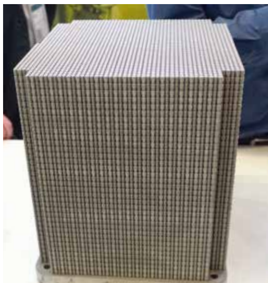
Per batch print autobieltoeleverancier Brose 92.000 onderdelen voor in de autostoelen die het produceert. Dit gebeurt op een SLM 280 van SLM Solutions, recent gekocht door Nikon.
